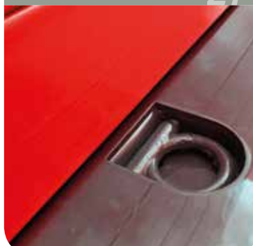
Versenkte Bindehaken Ganci integrati nel pianale
