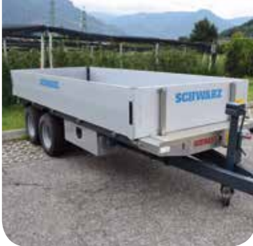
Federhebung für Bordwände Molla per alzare le sponde
