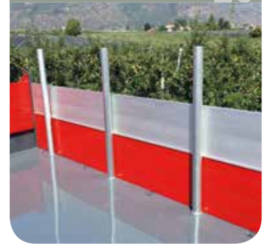
Zurmulde drehbar mit Gummilippe
