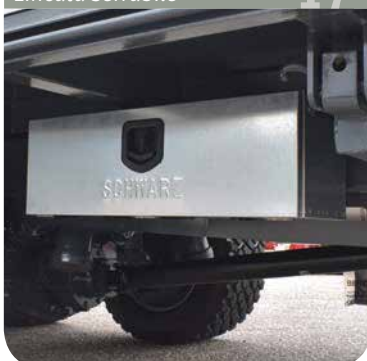
Schutzblech seitlich zwischen Rungen Lamiere di protezione laterali tra i portanti
