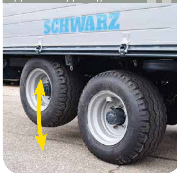
Achsheber hydraulisch – Kolben, auf Anfrage doppelwirkend Alzassale idraulico semplice oppure a doppio effetto
