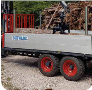
Hydraulische Schuttklappe Sponda posteriore idraulica
