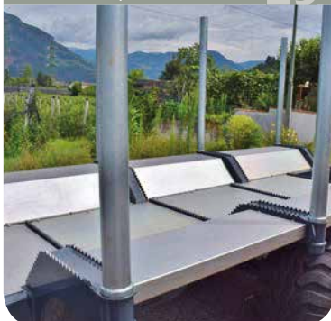
Schutzblech seitlich zwischen Rungen Lamiere di protezione laterali tra i portanti
